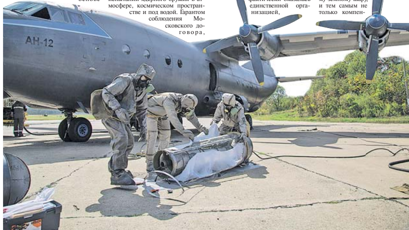
Съём фильмограмм с фильмогондолы после отбора проб воздуха.
