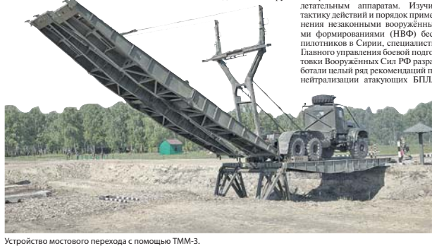
Устройство мостового перехода с помощью ТММ-3.
