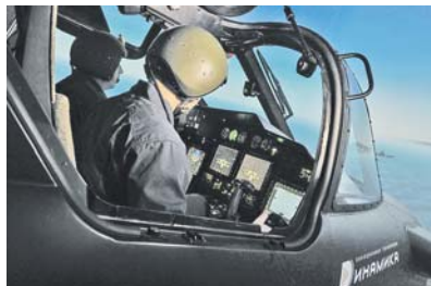
Кабина тренажёра не просто точно копирует вертолётную, но и правдоподобно имитирует поведение воздушного судна в воздухе.
