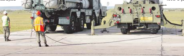
На одном из этапов учения специалисты МТО отработывали презарядку транспортно-пусковых контейнеров зенитного ракетного комплекса С-300.
