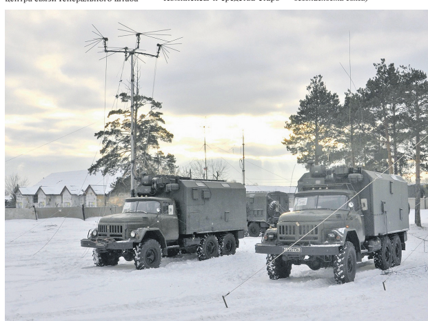
Комплекс контроля безопасности связи Р-452К.
