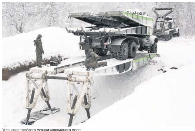
Установка тяжёлого механизированного моста.
