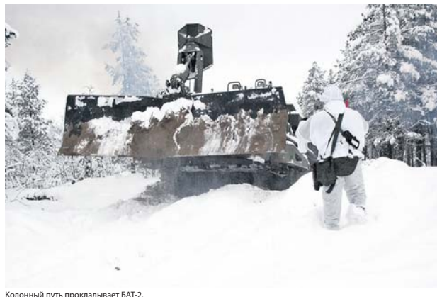
Колонный путь прокладывает БАТ-2.
