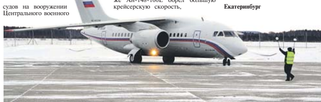
Верхнее расположение крыла и двигателей – явное преимущество.
