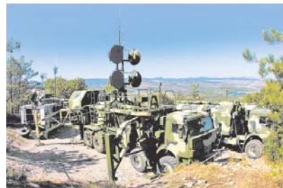
Телекоммуникационный комплекс «Редут-2У».
