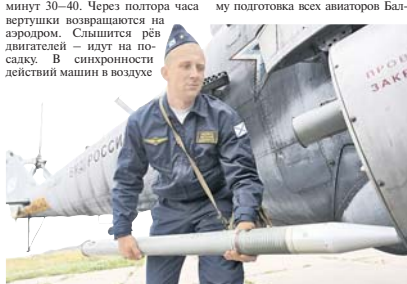
Установка на вертолёт неуправляемой ракеты скумулятивным зарядом.
