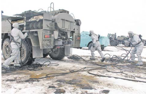
Развёртывание авторазливочной станции APC-14 KM для проведения специальной обработки военной техники.
