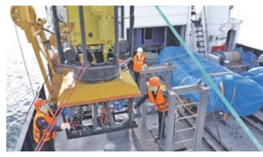
Процесс обследования места затопления теплохода «Армения» в Чёрном море на глубине 1500 метров с применением телеуправляемого необитаемого аппарата. Фото Центра подводных исследований РГО.
