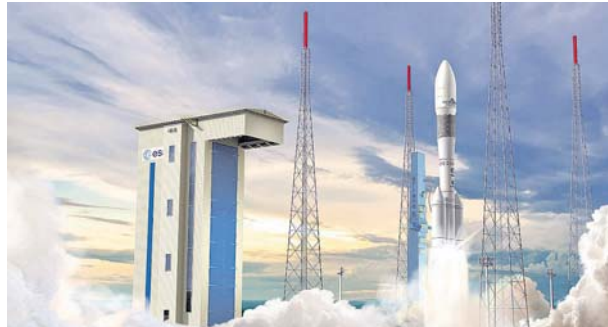
Ракета-носитель «Ариан-6» предназначена для выведения полезной нагрузки на низкую опорную орбиту (высота — около 200 км) или геопереходную орбиту.
