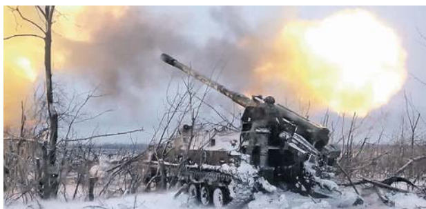
— Самоходная артиллерийская установка — дальноточное артиллерийское вооружение. Стреляет снарядами калибра 152 миллиметра. Дальность стрельбы 30 километров. Хорошая скорость заряжания, скорость наводки
